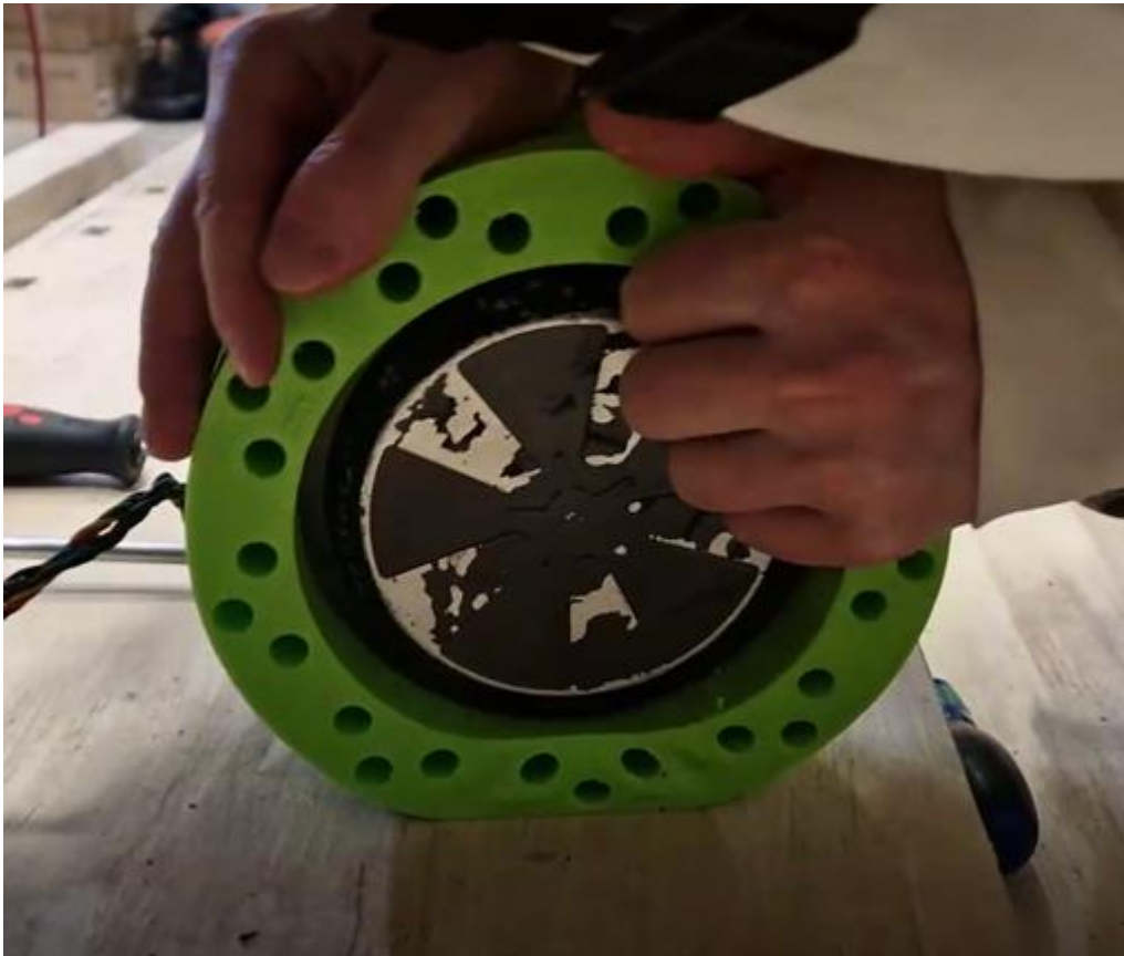
Kuva 32. 3D-tulostetun renkaan kasaanpainumisen testausta pöydällä
