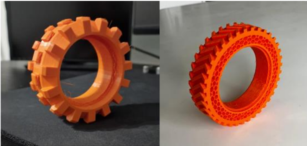
Kuva 25. 50% kokoisia testitulosteita, oikean mallin löytämiseksi.
