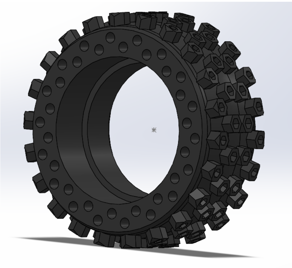
Kuva 24. CAD-malli renkaan viimeisestä versiosta
