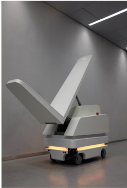
Kuva 32. Valmis kuori kasattuna MiR100 robotin päälle.
