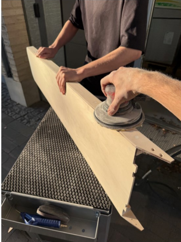
Kuva 27. Kaikki kuoren osat kitattiin ja hiottiin huolellisesti ennen maalaamista.
