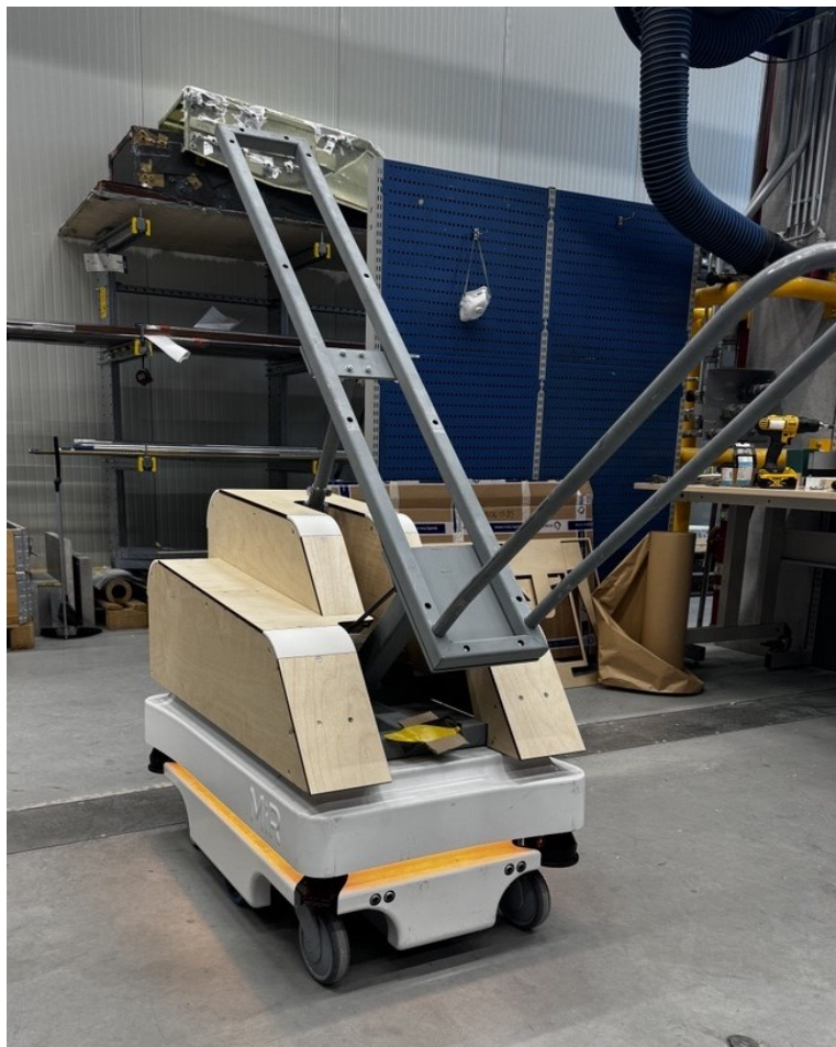
Kuva 28. Kuoren osien kokeilua MiR100 robotin päälle ennen maalausta.
