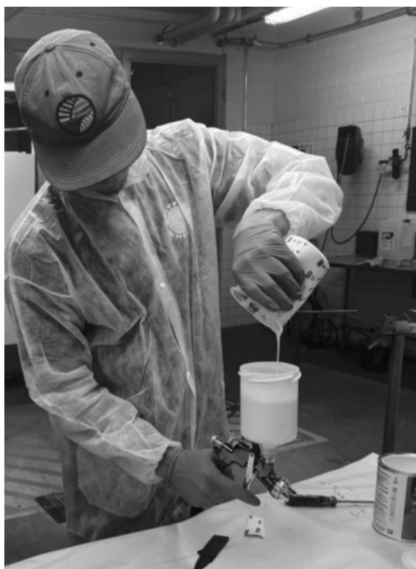
Kuva 29. Osat ruiskumaalattiin ja lakattiin Metropolian pintakäsittely laboratoriossa.
