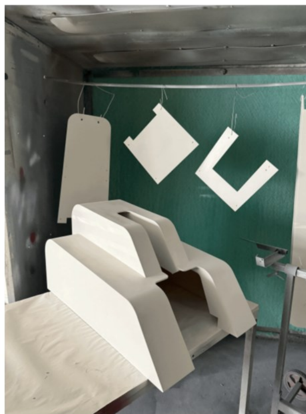
Kuva 29. Osat ruiskumaalattiin ja lakattiin Metropolian pintakäsittely laboratoriossa.
