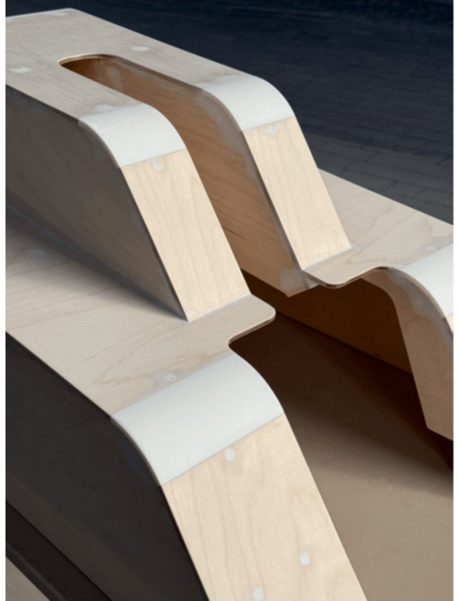
Kuva 27. Kaikki kuoren osat kitattiin ja hiottiin huolellisesti ennen maalaamista.
